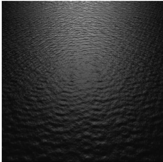
FIG. II.44 – Image ( $500 \times 500$  pixels) de la luminance de la surface de mer.  $\theta_s = 36^\circ$ ,  $\phi_s = 0^\circ$ ,  $\lambda_0 = 4 \mu\text{m}$ ,  $u_{10} = 15 \text{ m/s}$ ,  $\theta_i = -40^\circ$  et  $\phi_i = 0^\circ$ . Le capteur est placé à une hauteur de **1.5 km**.
